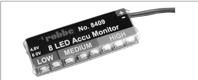
Accumonitor ..... Best. nr. 8409 De robbe 8-led accu-monitor is een digitale precisie spanningsmeter, om ontvangeraccu's met een nominale spanning van 4,8 of 6 Volt (een 4 of 5-cellige NiMH/NC -accu) te controleren. Meetbereik: 4 cellen = 4,3 tot 5,1 Volt 5 cellen = 5,2 tot 6,2 Volt
