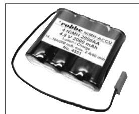
Powerpack Best.nr. 4551 4 NiMH 2000AA vlak NiMH-accu met hoge capaciteit, 4,8 V, 2000 mAh, gew. 115 gr. Afmetingen: 51 x 57 x 14,5 mm. Laadstroom max. 2 A.
